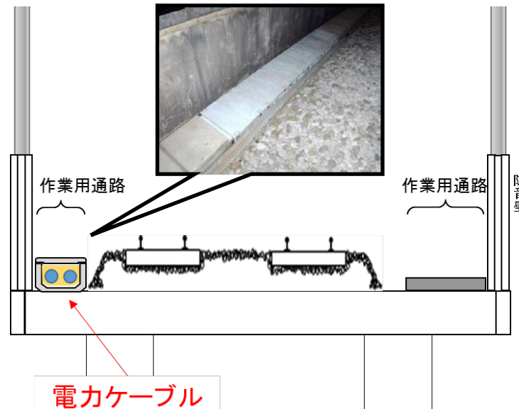
線路断面図：電力ケーブルの設置環境
